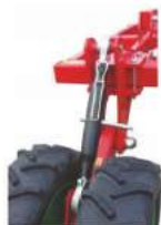
Regulacja położenia kół podporowych
