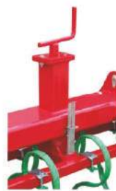
Mechanizm regulacyjny głębokości pracy zębów sprężynowych
