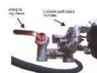
Regulator siły hamowania z zaworem sterującym
