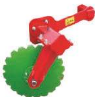
Regulacja pochylenia talerza zewnętrznego
