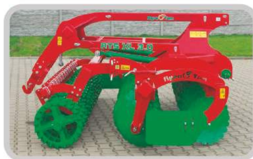
Zaczepek sprzęgu do siewnika – (uwaga występuje wersja bez hydropaku – posiada uszy do późniejszego montażu)
