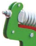
Regulacja napięcia sprężyny
