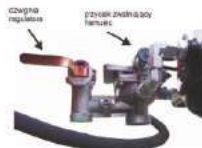
Regulator siły hamowania z zaworem sterującym
