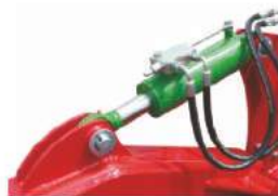
Zawór odcinający w układzie hydraulicznym wózka
