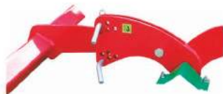
Regulacja głębokości pracy agregatu
