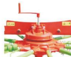
Śruba regulująca wysokość położenia ramion zgrabiarki
