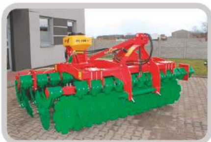
Hydrauliczna regulacja głębokości pracy agregatu GT XL
