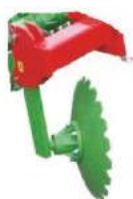
Regulacja głębokości pracy krojów talerzowych
