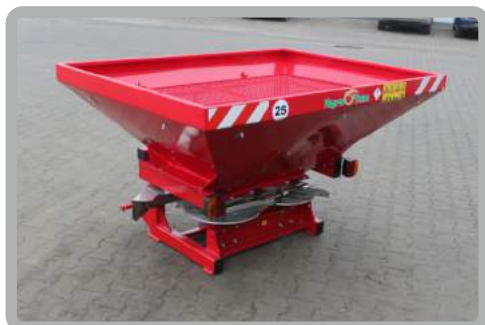
Dwie tarcze kwasoodporne z regulowanymi łopatkami
