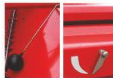
Mieszadło, czujnik oraz wskaźnik poziomu ziarna
