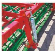
Przednia włoka regulowana zabezpieczeniem sprężynowym
