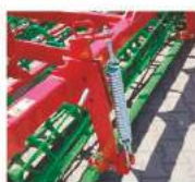
Przednia wiązka regulowana zabezpieczeniem sprężynowym
