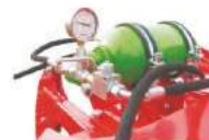
Układ hydrauliczny głębosza GHL (zawór odcinający, manometr, akumulator hydropneumatyczny)
