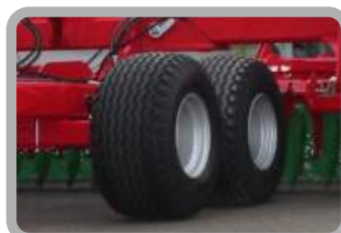
Wzmocnienie poprzez zastosowanie drugiej osi
