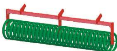
Wał ceownikowy, średnica 600 mm
