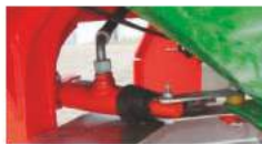
Silownik hydrauliczny sterujący dopływem nawozu do tarcz wsiewających
