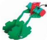
Regulacja pochylenia talerza zewnętrznego
